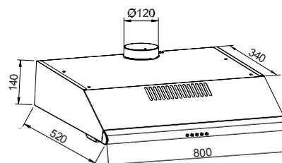
Sortie d'air sur le dessus ou l'arrière de la hotte
